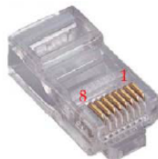
Рисунок 4 – Контакты разъема RS-485 на стороне ДФКУ
